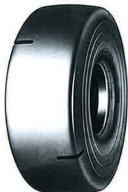
Neumático reforzado, con banda lisa y profunda para una mayor vida de desgaste y fuerte resistencia al corte. Perfil único con protector lateral para mejorar la resistencia a los cortes tanto en hombros como en la pared lateral.
