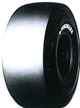
Neumático apropiado para cargadores trabajando en minas subterráneas. La banda profunda y lisa más sus laterales reforzados dan al neumático gran resistencia al corte para una larga vida útil en servicio.
