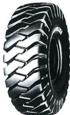
Diseño tipo roca especialmente proyectado para uso en distancias cortas sobre superficies abrasivas. Su banda profunda, más que el Y523, proporciona una alta resistencia al corte y larga vida útil.
